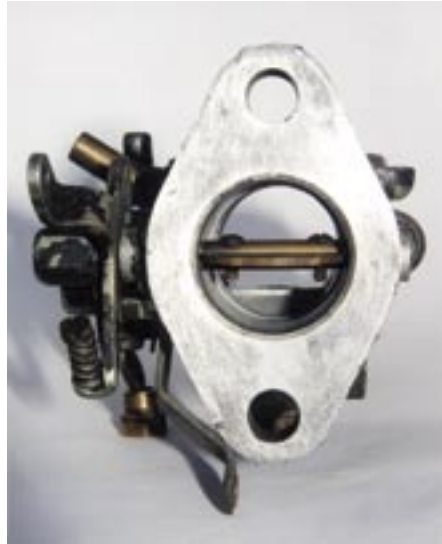
Standard SU carburettor spindle.
